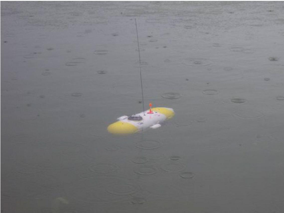
Hier ist schon ein Teil der ausgetauchten Kuppel zu sehen. In ihr befindet sich der Schnorchel. Er ragt bis knapp unter ihr Belüftungsloch. Der Tauchtank kann jetzt gelenzt werden und sorgt für einen Auftrieb von etwa 2 N (200 g).
