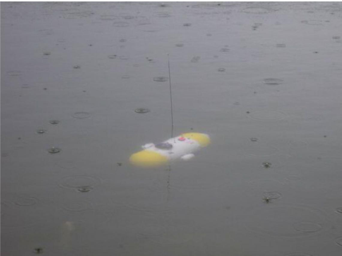
Hier ist die Alu gerade beim statischen Auftauchen. Dazu wurde die Regelzelle gelenzt. Mit Hilfe des Tauchtanks kann nicht aufgetaucht werden, da zum Lenzen erst die Schnorchelspitze an die Wasseroberfläche gelangen muss, um Luft einsaugen zu können.
