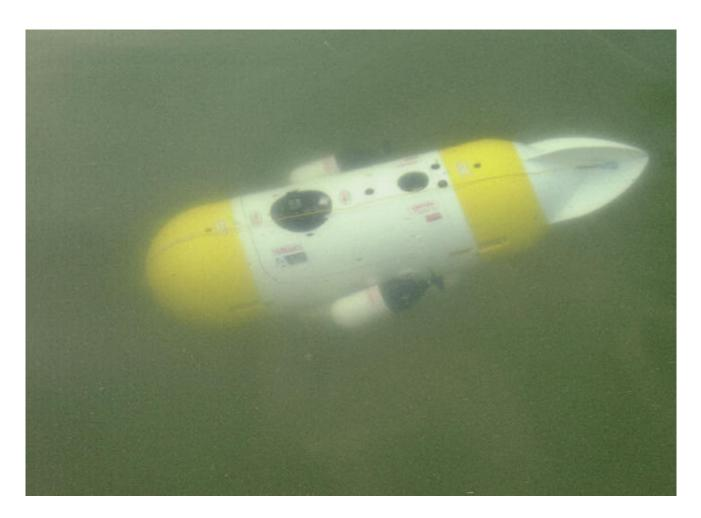
Durch die 40er Propeller (Graupner, 3-Blatt, Kunststoff) fühlt sich die Alu jetzt an wie ein 'Fisch im Wasser'. Die Motoren ziehen die 40er problemlos durch und ich habe zum ersten Mal das Gefühl, dass dieses Boot im Wasser geboren sein könnte. Es ist kein umgebautes Schiff das nebenbei auch noch ein bisschen tauchen kann, sondern ein waschechtes U-Boot, das dem Steuermann ein absolut sicheres Gefühl vermittelt. Es ist nicht mehr so, dass die Alu als ein Spielball des Wassers erscheint.
