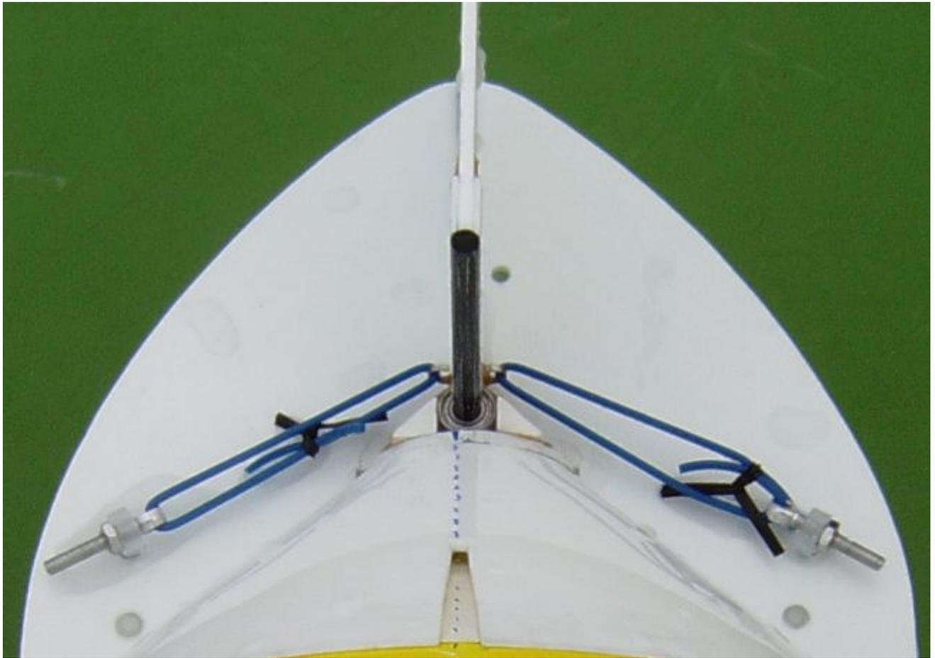
Die Gummibänder halten die Flosse solange gerade, wie keine größeren Kräfte auf die Flosse einwirken. Wenn die beiden Gondeln beispielsweise das Boot auf der Stelle drehen wollen, dann wird die Flosse durch die auftreffende Seitenströmung des Wassers komplett zur Seite geklappt.
