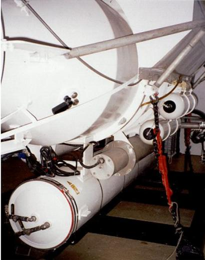
Die Hydraulik-Einheit ist in dem grauen Rohr untergebracht zwischen dem Akkubehälter ganz unten und den beiden oben liegenden weißen Pressluftflaschen.
