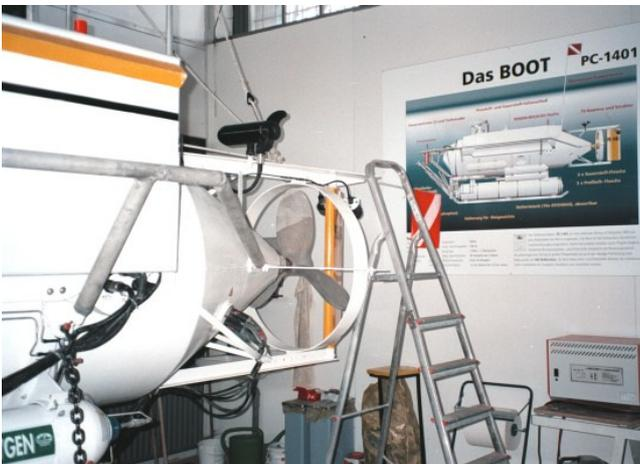
Auf dem oberen Heckausleger ist noch ein Strahlruder erkennbar. Am Heckruderblatt sind ein Lichtstrahler und eine Videokamera befestigt. Sie sind auf dem Bild nur undeutlich zu erkennen.
