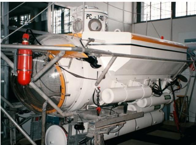
Die rote "Boje" am Bug ist ein Voraus-Sonar. Die weiße Flasche etwa in der Mitte des Bildes enthält zusätzlich zu den beiden Flaschen auf der Steuerbordseite ebenfalls Pressluft.
