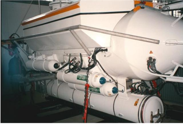
Das große unten liegende Rohr ist wie schon gesagt der Akkubehälter. Er beherbergt 16 Akkus a' 6 V/240 Ah und ist abwerfbar. Die beiden hinteren Flaschen mit den grünen Aufklebern enthalten Sauerstoff.
